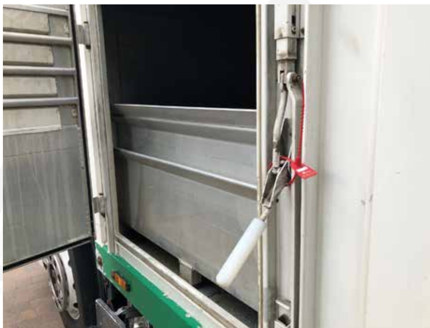
Fot 1. Plomba założona w sposób umożliwiający otwarcie drzwi rewizyjnych bez uszkodzenia plomby.
