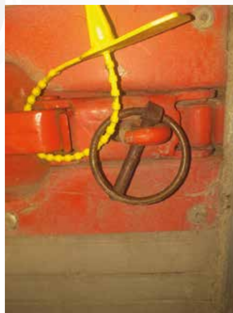
Fot 3. Plomba założona za zawleczkę, po wyjęciu zawleczki można otworzyć drzwi.
